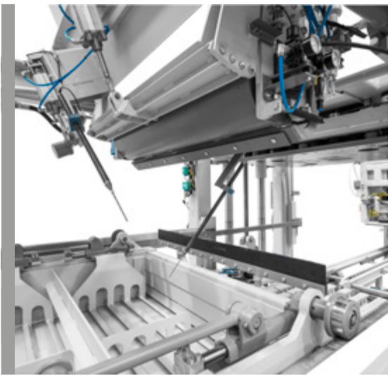
Разработанная Поятос система точного заполнения пресс-формы бетоном. Энкодер для управления распределительным ящиком.
