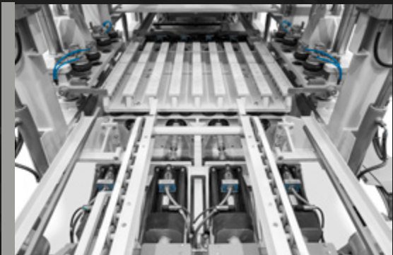
Два независимых вибрационных стола в стандартной комплектации для лучшей компенсации наполнения. Непрерывная смазка вибраторов в масляной ванне (минимальное обслуживание).
