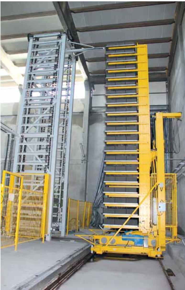
Готовая продукция доставляется в туннели сушки автоматически при помощи штабелера, адаптированного к характеристикам каждого конкретного проекта в отношении количества уровней, максимальной грузоподъемности, возможности поворота на 180° и т. д.
